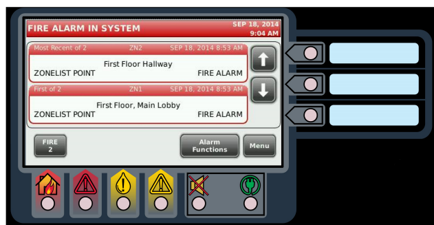
Figura 2: Pantalla táctil con indicadores de estado LED
